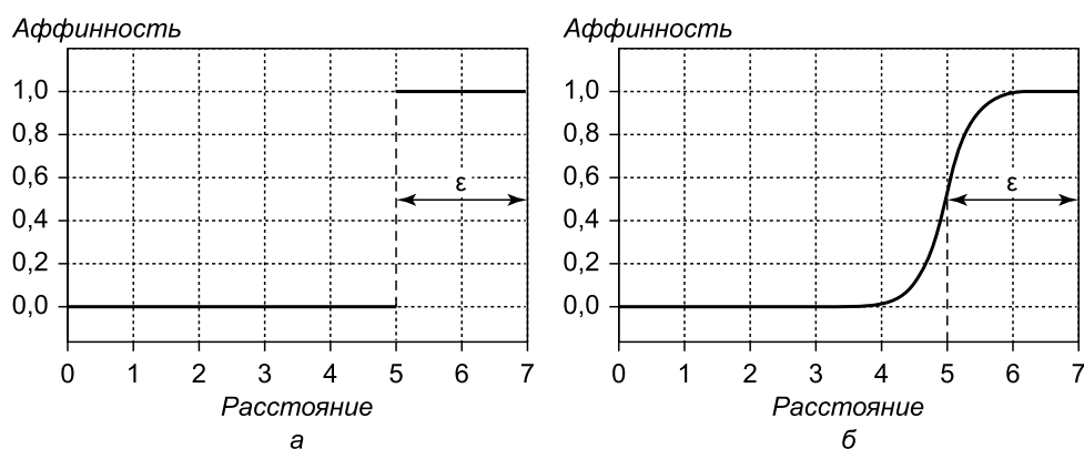
Рис. 4.3. Зависимость между аффинностью и расстоянием Хэмминга для антитела длины L = 7 с порогом аффинности E = 2 : а – пороговая функция, б – сигмоидальная функция
